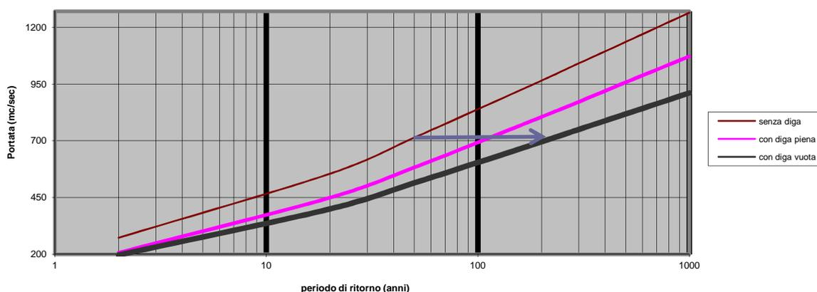
**Fig.2 - Effetto di laminazione della diga sulle portate di piena del F. Alento a Foce . Area del bacino sotteso 415 Km<sup>2</sup>**
